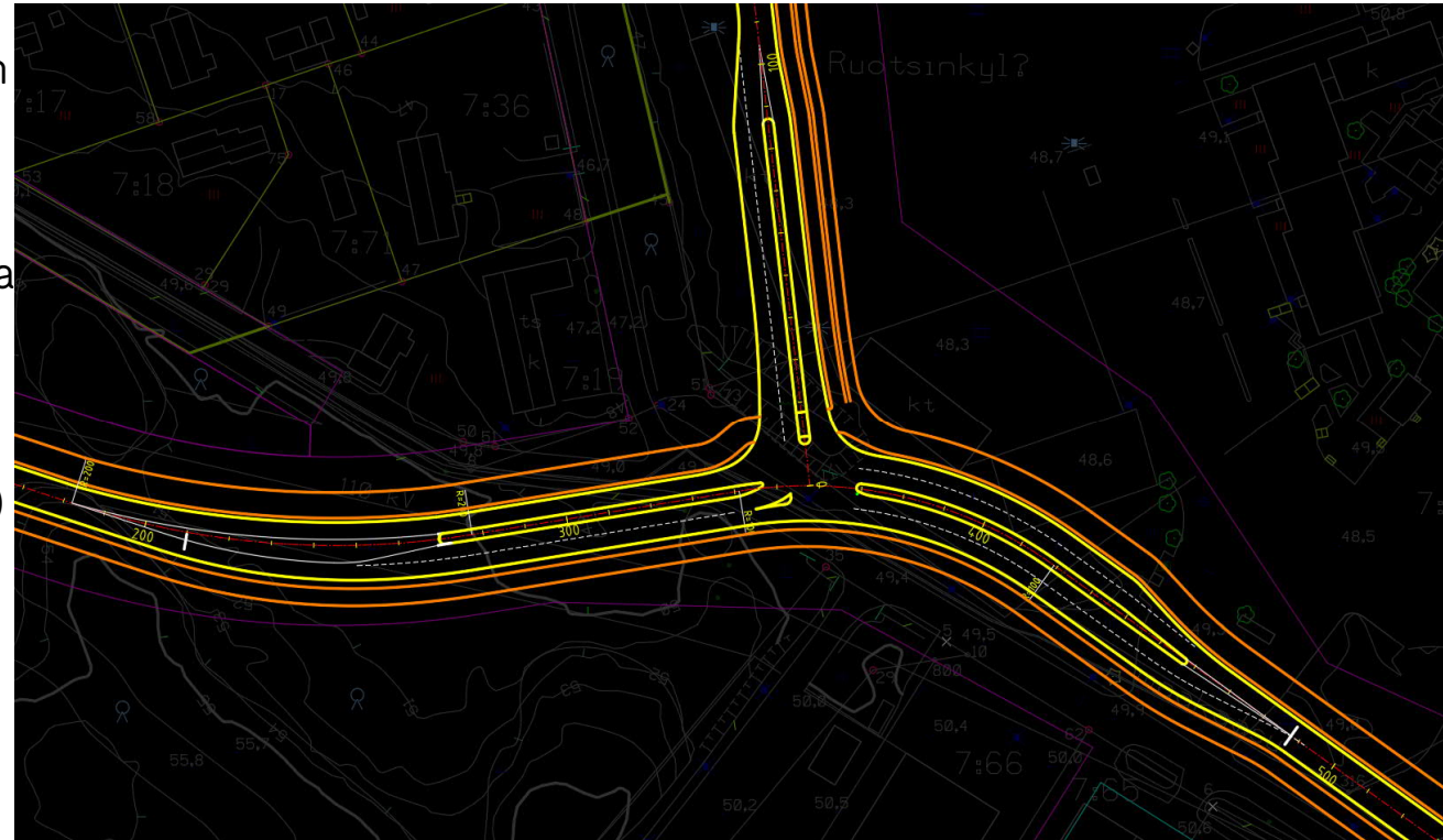
Kuvassa on esitetty valo-ohjatun liittymän järjestelyt
